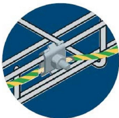
Puesta a tierra de bandeja, con cable de 16 mm 2
